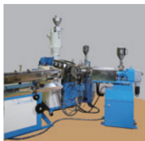
多層プラスチックチューブ製造装置
